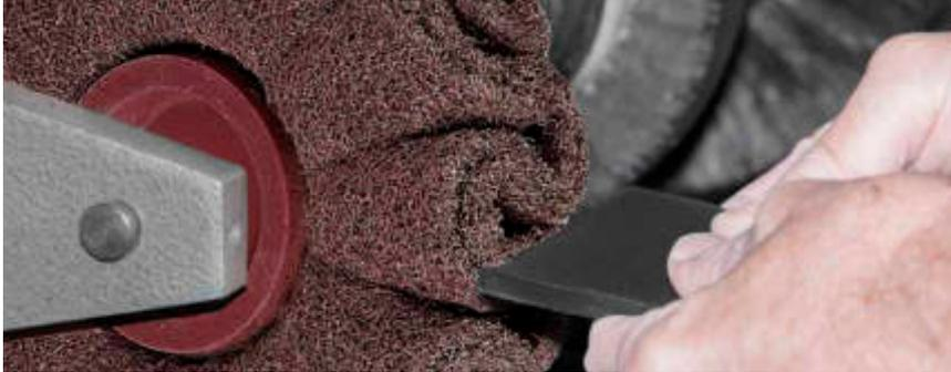
LUKAS-Faltenringe aus Schleifvlies werden auf einer Welle zu Walzen unterschiedlicher Breite zusammengepackt. Durch Zugabe von Wasser oder dünnflüssigem Öl können Sie die Standzeit dieses Werkzeugs zusätzlich erhöhen: Wasser ergibt auf fast allen Metallen matte, auf Aluminium sehr matte Oberflächen, Öle ergeben Seidenglanz-Finish.
